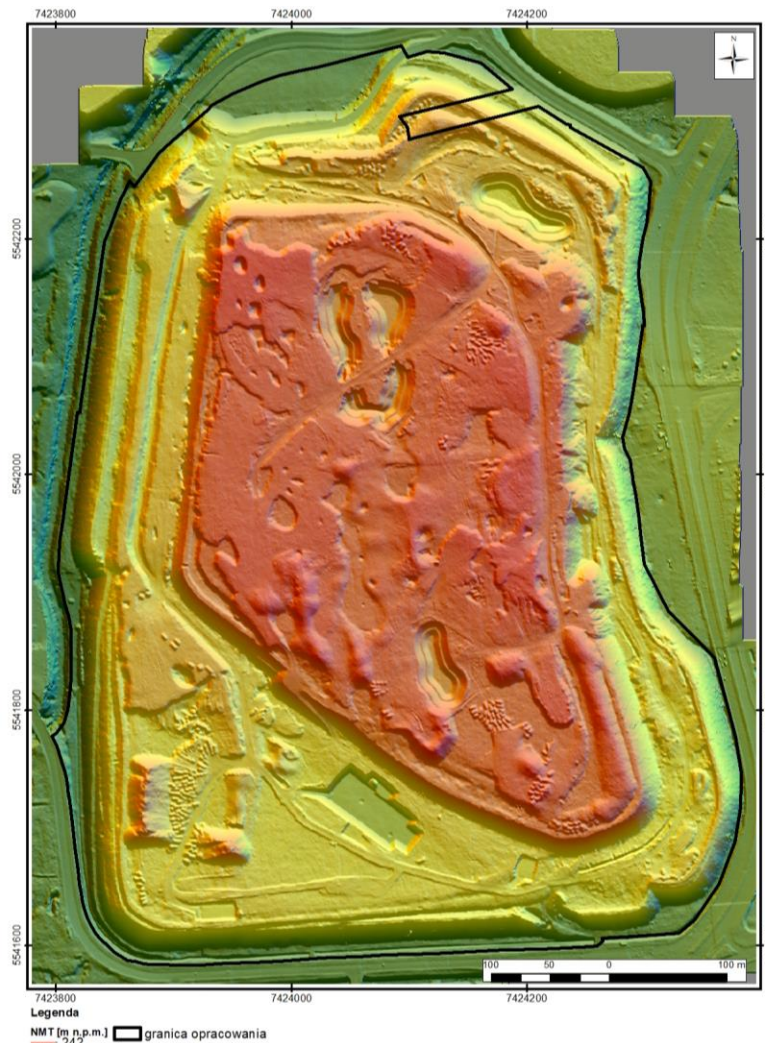
Cieniowany NMT (ang. hillshade) wygenerowany na podstawie chmur punktów ULS LiDAR
